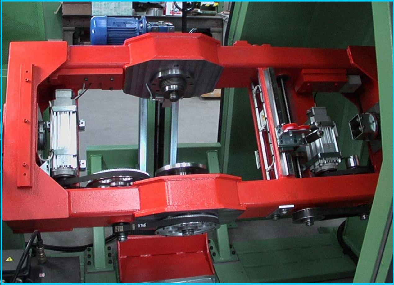
Machine est dédié à l'assemblage des produits fragiles comme câbles à fibre optique, câbles blindés tresses en verre ou cuivre et câbles isolé en P.T.F.E.
